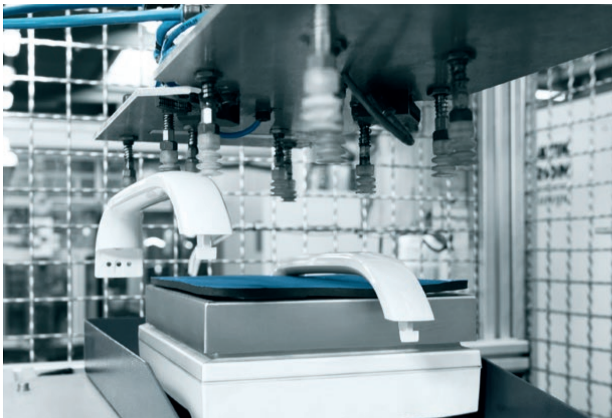
Gasunterstützte Produktion von Türgriffen
