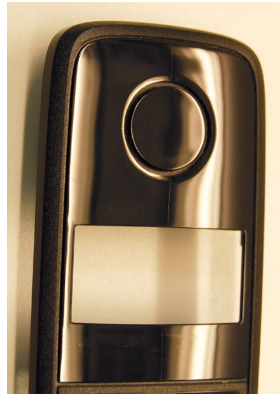
Bild 2: Spritzteilkontur mit Durchbrüchen zur Darstellung von Bindenähten
