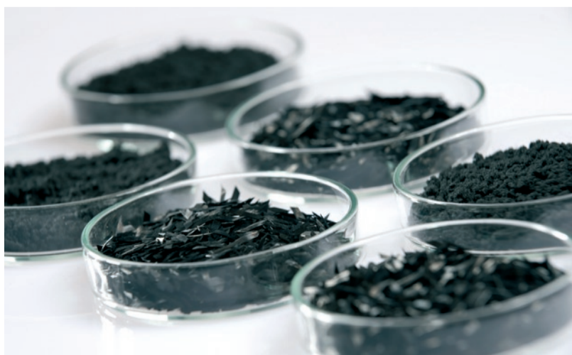
Abfall-Spulen (l.) und aufbereitetes Rohmaterial unterschiedlicher Körnung (o.).
